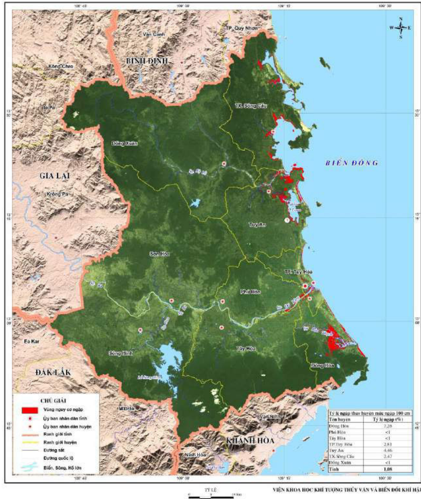
Hình B16. Bản đồ nguy cơ ngập ứng với mực nước biển dâng 100 cm, tỉnh Phú Yên
