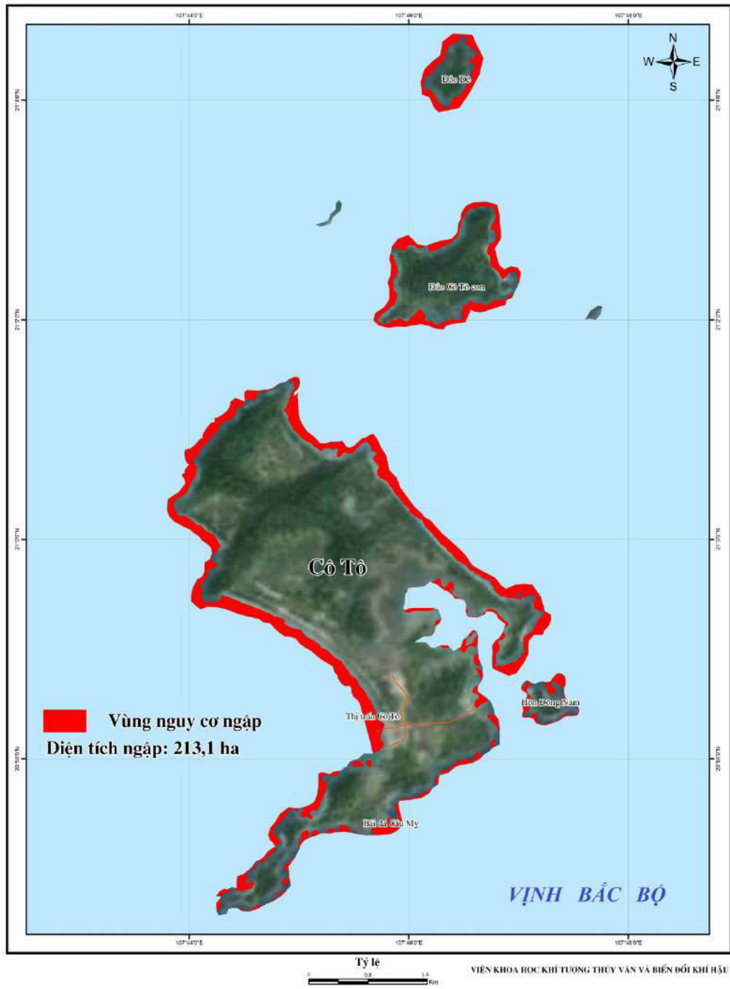
Hình B38. Bản đồ nguy cơ ngập ứng với mực nước biển dâng 100 cm, đảo Cô Tô, tỉnh Quảng Ninh
