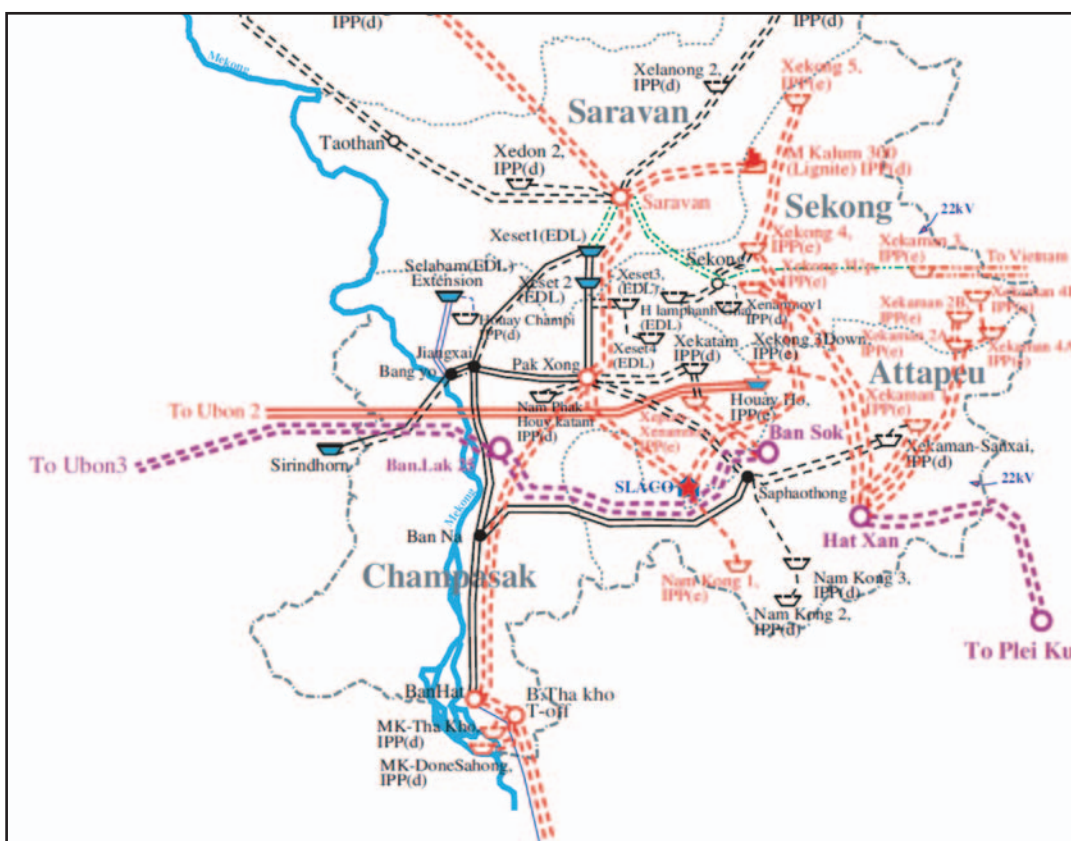
ផែនទីការភ្ជាប់តំបន់ទំនប់អគ្គិសនីទៅនឹងបណ្តាញ Ban Sok-Pleiku ប្រភព៖ អគ្គិសនីប្រទេសឡាវ
